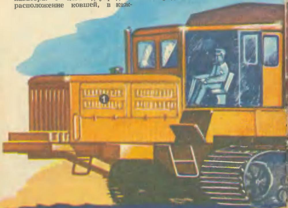
Два двигателя на одном экскаваторе — явление необычное. Именно столько установлено на ЭТР-301. Один, мар-
