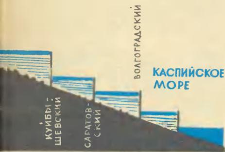
**2** Такой сложный путь вверх-вниз придется совершить водам северных рек, пока они попадут в Каспийское море. Сначала насосы поднимут их до наивысшей отметки. Затем они устремятся вниз, через весь каскад волжских гидроэлектростанций. И не только вернут затраченную на их подъем энергию, но и дадут значительно больше. Вот почему с энергетической точки зрения вариант переброски северных рек считается экономичным.
