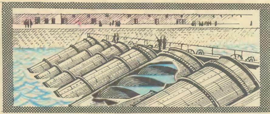
под землей прочные водопроницаемые трубы из самой земли. Созданная система осушения работает в 6—7 раз дольше, чем обычный «земляной» дренаж.
